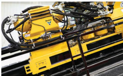
**COPPIA DI TORSIONE ELEVATA.** L'operatore può regolare la coppia di torsione che va da 40.675 Nm a 73.214,2 Nm (30.000 ft-lb a 54.000 ft-lb), con una coppia massima molto vantaggiosa per operare con alesatori di grande diametro in progetti di installazione importanti.
