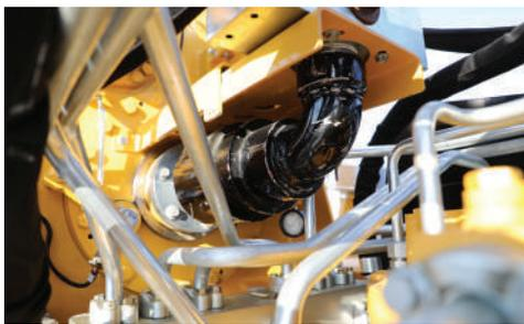
**FLUSSO FANGHI.** Il sistema fanghi ottimizzato è equipaggiato con 4 tubi da 38 mm e un albero della torretta da 76 mm. In questo modo è possibile pompare un volume maggiore di fluidi nel foro.
