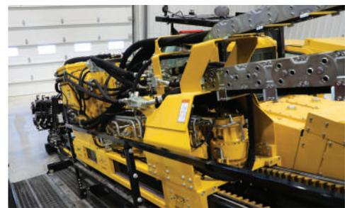
**VELOCITA' A TERRA.** L'elevata capacità di avanzamento della torretta è d'aiuto nel ciclo di serraggio aste quando si aggiungono o si tolgono aste e aiuta a ridurre i tempi di tiro.
