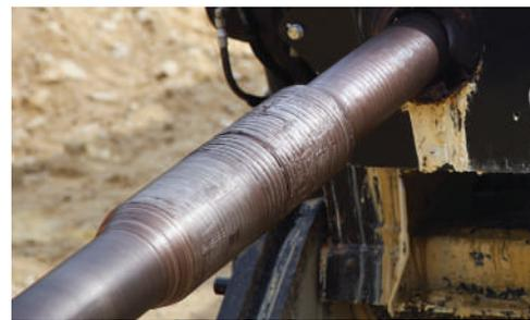
**VANTAGGIO ASTE.** Il perforatore è equipaggiato con una cremagliera da 9,1 m che permette di utilizzare una gamma di aste con diametri diversi e con diverse lunghezze, da 8,3 fino a 9,8 m, aiutando a ridurre gli interventi di cambio asta – un setup perfetto per ogni progetto di perforazione.
